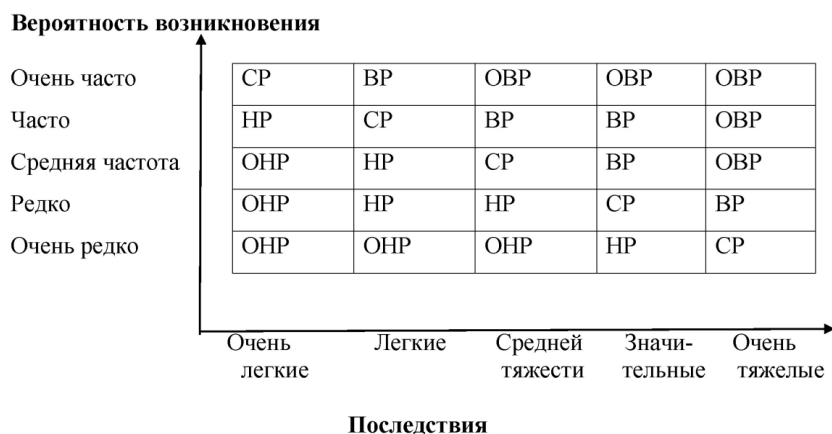
Рис. 1. Матрица дифференциации рисков в зависимости от вероятности их возникновения и тяжести последствий
